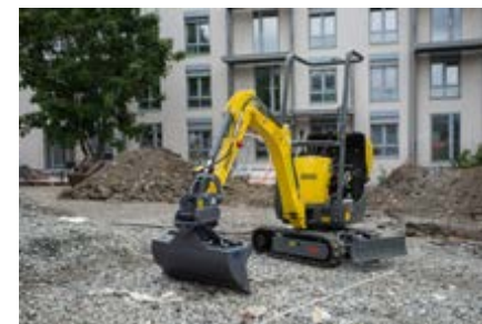
Hybrid gravemaskin som kan gå både på diesel og strøm. (Foto: Mari Gisvold, tu.no)
