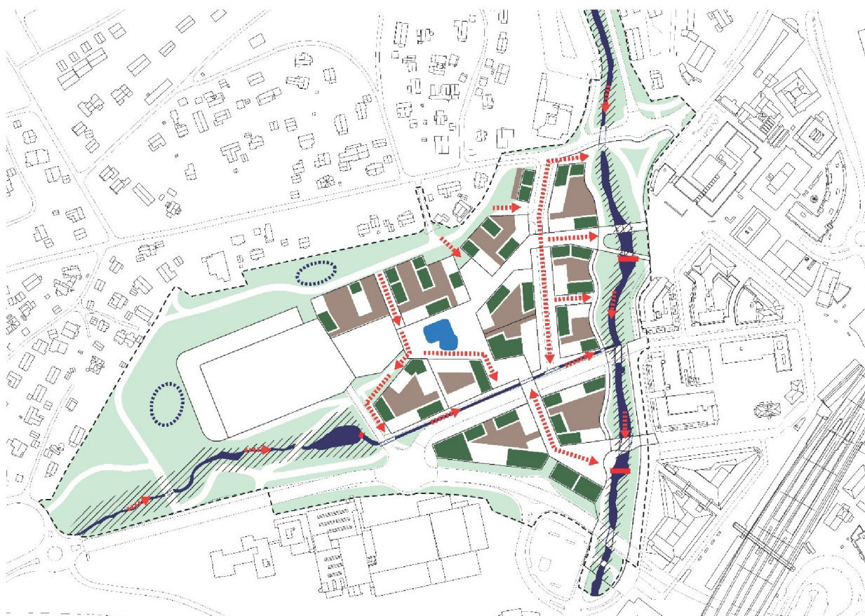
Illustrasjon: Flomveier og overvannshåndtering
