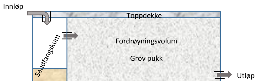
Figur 2-4. Skisse av fordrøyningsvolum under bakken.
