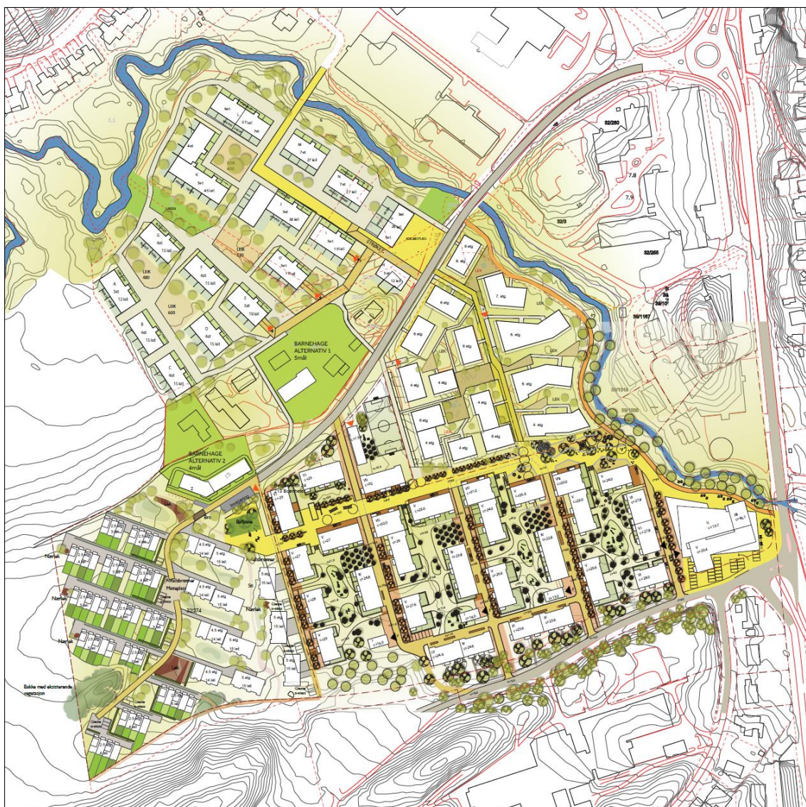
Figur 2-2: Prinsippplan for vestre del av området, med nye boliger. Øst for Neselva er det foreløpig ikke konkretisert ny bebyggelsesstruktur, men næringsområdene her kan utvikles med en større andel boliger over tid. Bebyggelsen i søndre del av området er justert, se figur neste side.
